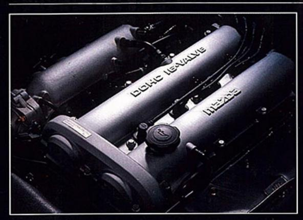
エンジンは 最高出力 130ps/6500rpm(ネット\*1)、最大トルク 16.0kg-m/4500rpm(ネット\*1)を発生する自然吸気 1800DOHC 16バルブ"BP-ZE [RS]"分厚い低中速トルクによるハイレスポンス、16bitコンピューターの緻密な制御ロジックによるストレスのない伸び
