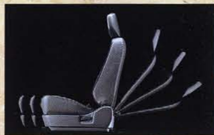
フロントシートスライド&リクライニング シートスライド、リクライニングのピッチをより細かく設定。体に合った最適なドライビングポジションを選ぶことができる。
