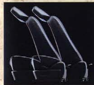
助手席ウォークイン ワンタッチで前方へ大きくスライドし、後席への乗降もスムーズに行える。
