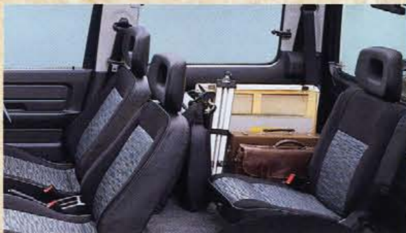
フロントシートスライド&リクライニング シートスライド、リクライニングのピッチをより細かく設定。体に合った最適なドライビングポジションを選ぶことができる。
