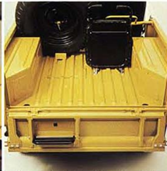
250kg積める荷台と乗車に便利なりヤークトステップと折りたたみ式の補助シート。
