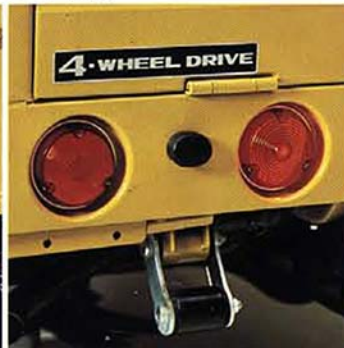
左折右折がはっきりわかり、追突をふせぐ分離型ウィンカーランプとブレーキランプ。
