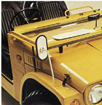
前たおしできるフロントウィンドウ。デフロスターが窓ガラスのくもりをふせぎます。
