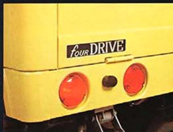
●ウイinkerランプとブレーキランプを分離し、後続車に右・左折がはっきりわかるよう配慮しました。
