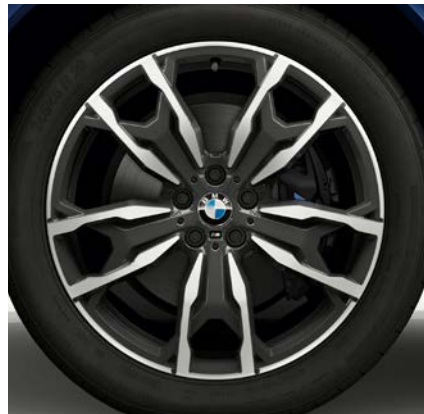
□ 20インチ M ライト・アロイ・ホイール・ダブルスポーク・スタイリング787M* : (フロント) 8J×20ホイール、245/45R20タイヤ、 (リア) 9.5J×20ホイール、275/40R20タイヤ [ランフラット・タイヤ]
