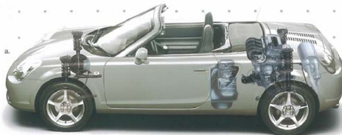
a. ミッドシップエンジンレイアウト b. 6速マニュアルトランスミッション シフトパターン c. 6速シーケンシャルマニュアルトランスミッションシフトパターン d. フロントブレース&リヤブレース
