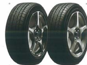
215/45R16 86W スチールラジアルタイヤ +16X7Jアルミホイール (光沢/リヤ) 215/45R16 86W スチールラジアルタイヤ +16X7Jアルミホイール (リヤ)
