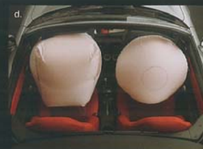
a. ハイマウントストップランプ b. リヤスポイラー c. フィン体タイプワイヤーブレード (運転席側) d. デュアルSRSエアバッグ
