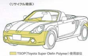
● TSOP (Toyota Super Olefin Polymer) 使用部位
