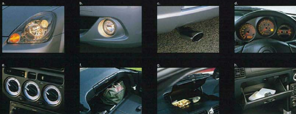
a. 4灯式ハロゲンヘッドランプ(ロービームプロジェクター) b. フロントフォグランプ c. マフラーカッター d. 3層シルバースター(写真は点灯時・6速シケンシャルMT車) e. ダイアル式ヒーターコントロールパネル f. ラゲージスペース(ラゲージリッド付) g. インストルメントセンターボックス h. グローブボックス(キーロック付)
