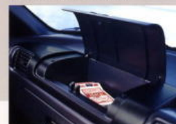
インストルメントサイドボックス(兼700SS-7リットル積載可能)
