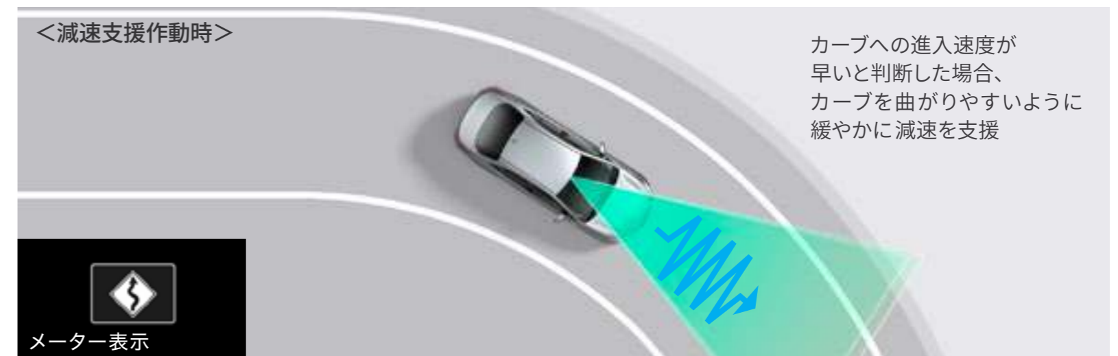
前方のカーブに対して自車の速度が速いと判定した場合、ドライバーのアクセルOFFに応じて緩やかに減速します。
