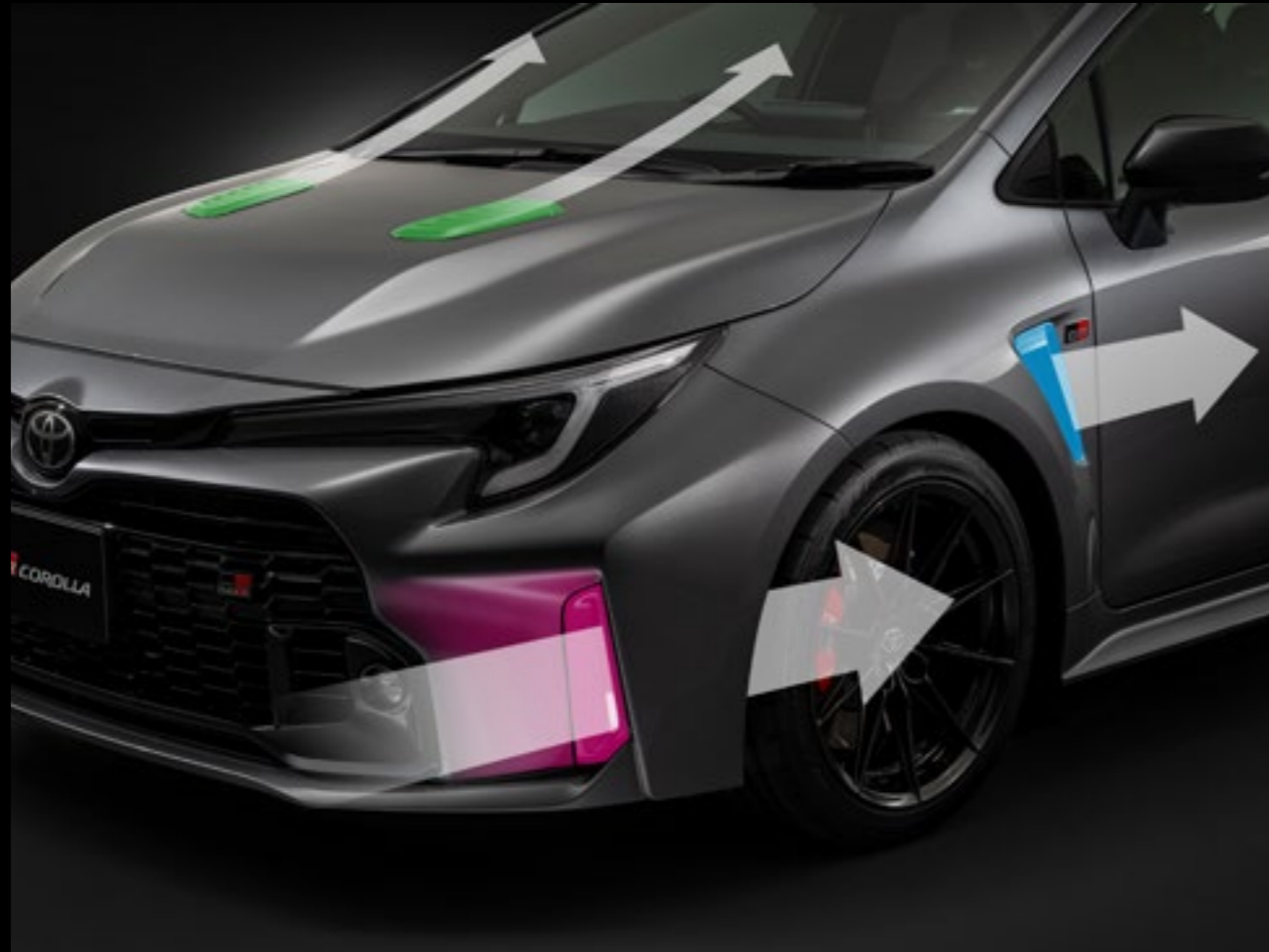
フロント ■ フードダクト（ダウンフォース向上、操安性向上） ■ フロントバンパーダクト（ドラッグ低減） ■ フェンダーダクト（操安性向上）
