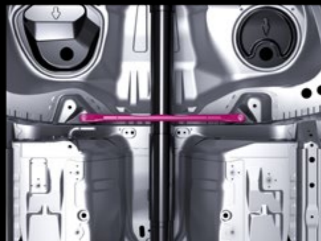
左: 床下トンネルブレース / 中央: タンク前床下ブレース / 右: リヤホイールハウス間ブレース
