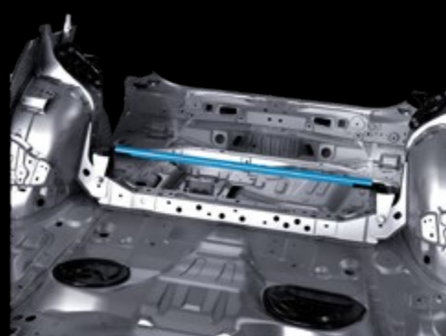
左: 床下トンネルブレース / 中央: タンク前床下ブレース / 右: リヤホイールハウス間ブレース
