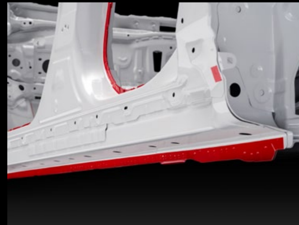
ロッカーフランジスポット溶接
