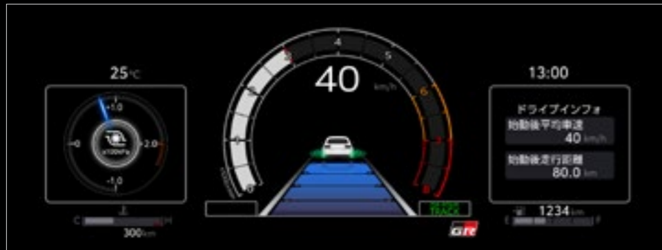
1眼タコリング表示 初期設定② 中央：走行支援 左：ブースト計 右：ドライブインフォメーション
