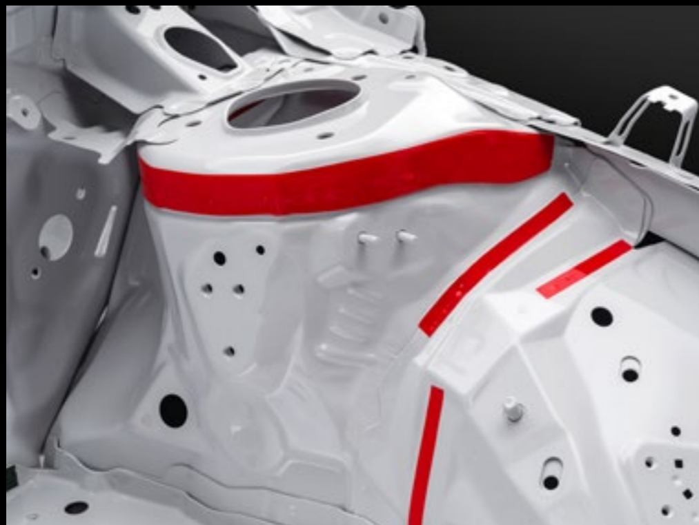
フロントサスタワースポット溶接
