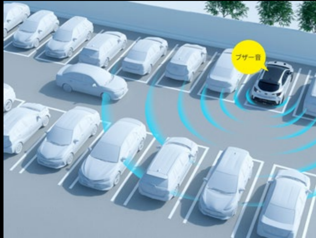
リヤクロストラフィックアラート作動イメージ
