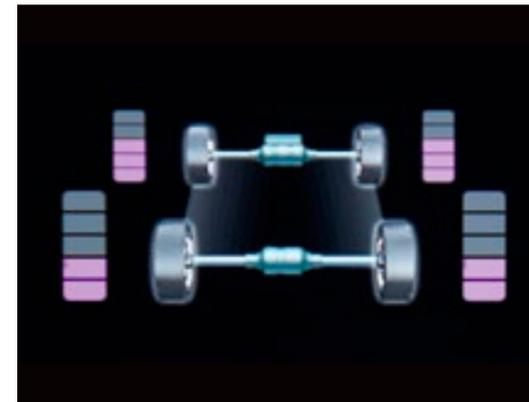
各輪にかかる駆動力（トルク）が大きい場合には目盛りの数が増加し、小さい場合には減少します。後輪の目盛りの数が少ないときはシステムが安定走行と判断し、燃費に寄与するために4WD機能を抑制している状態です。
