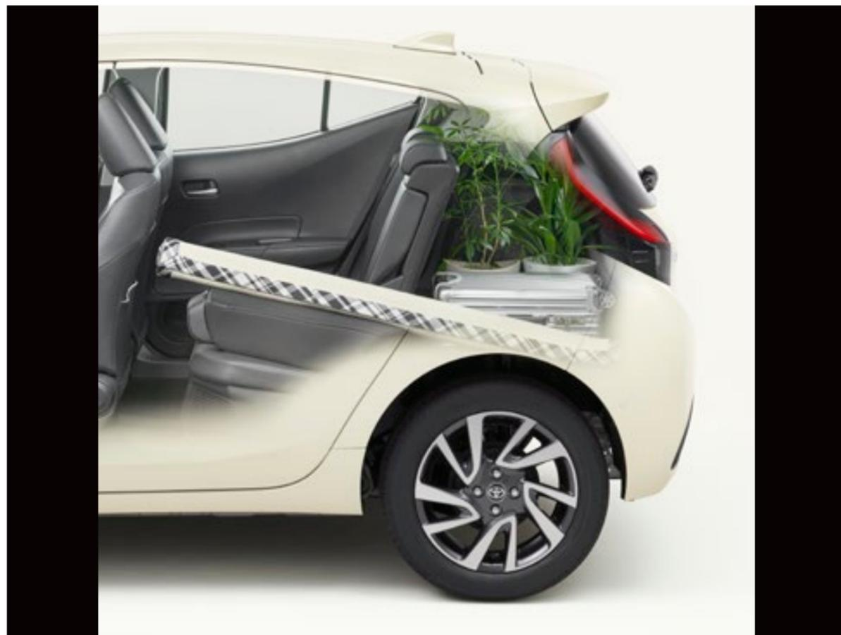
6：4分割可倒式リヤシート／片側倒し状態
