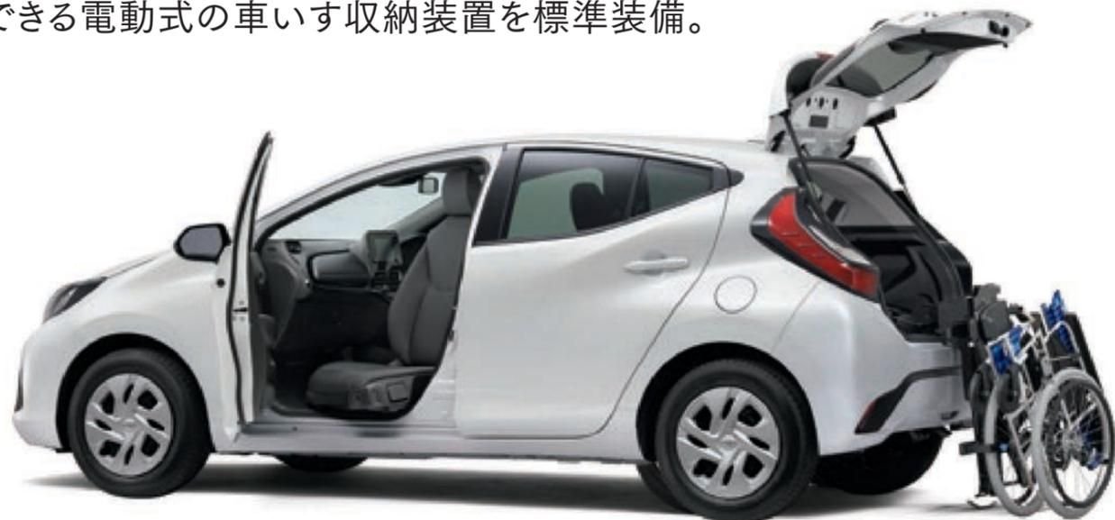
Photo: X (2WD) 車いす収納装置付車。ボディカラーのプラチナホワイトパールマイカ<089>はメーカーオプション。車いすは装備に含まれません。■車いす収納装置付車はメーカー完成特装車（TECS）のため、持ち込み登録となります。詳しくは専用カタログをご覧ください。
