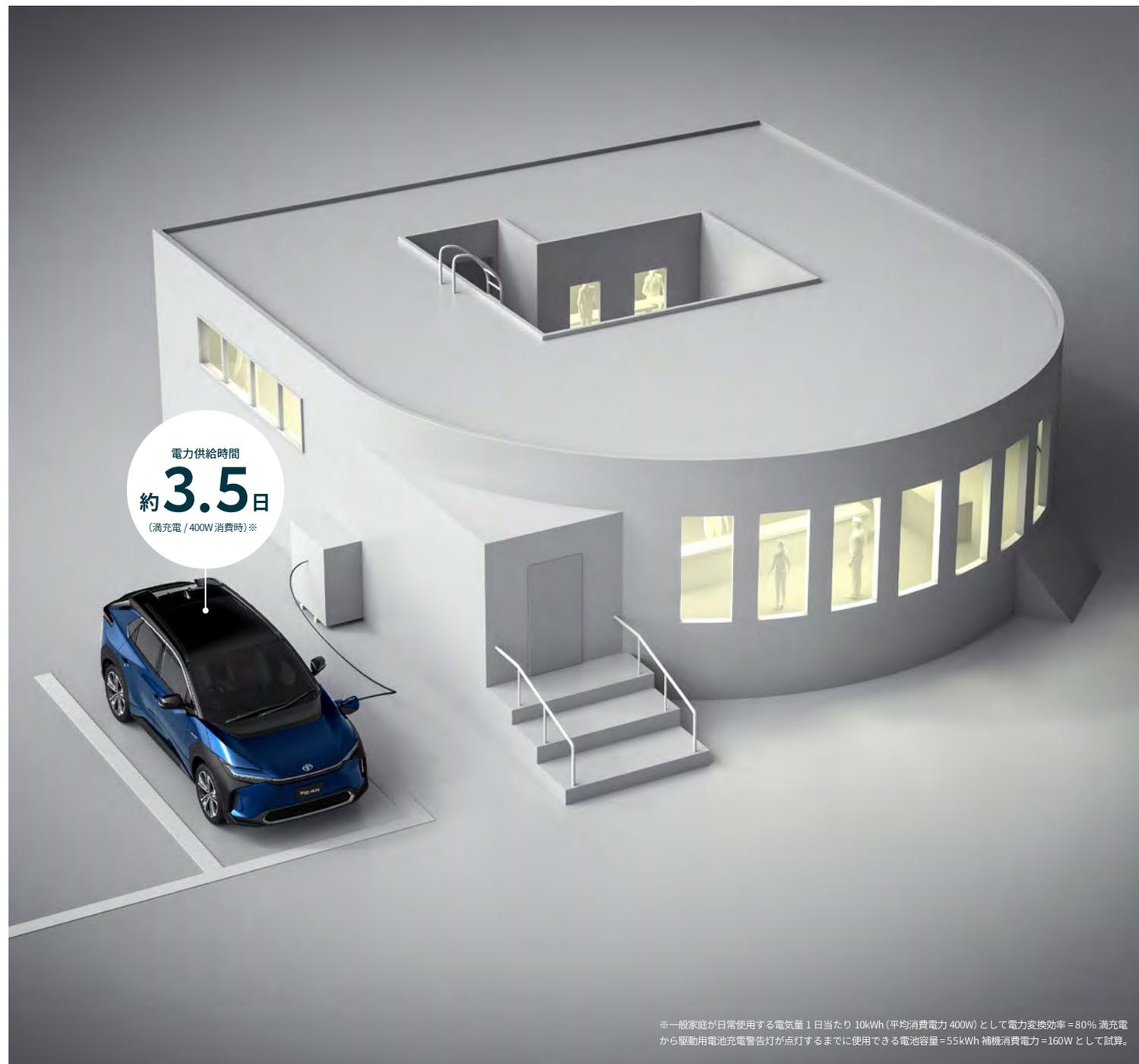
※一般家庭が日常使用する電気量 1日当たり 10kWh (平均消費電力 400W) として電力変換効率=80% 満充電から駆動用電池充電警告灯が点灯するまでに使用できる電池容量=55kWh 補機消費電力=160W として試算。
