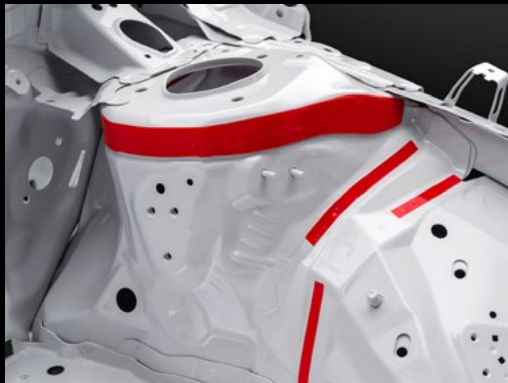
フロントサスタワースポット溶接
