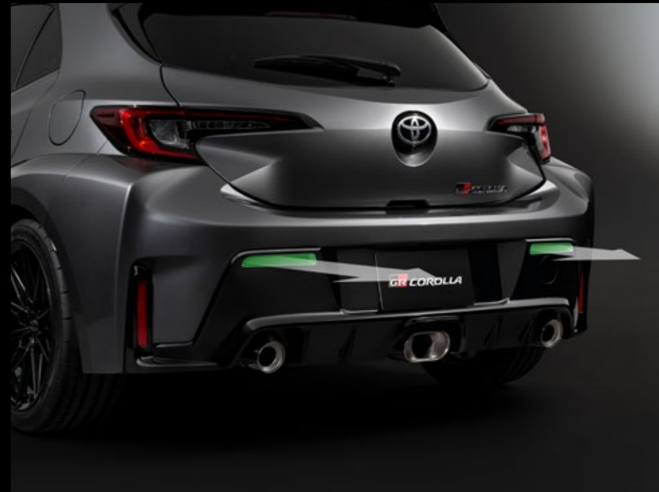
リア ■ リヤバンパー形状（操安性向上） ■ リヤバンパーダクト（ドラッグ低減、操安性向上）
