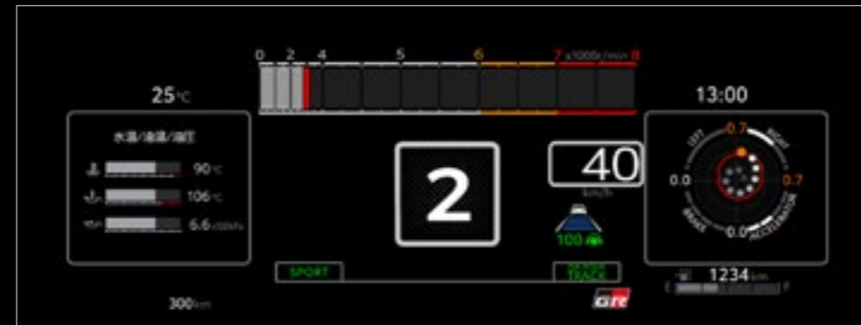
横タコバー表示 初期設定① 中央：ギヤ段 左：油水温 右：Gモニター
