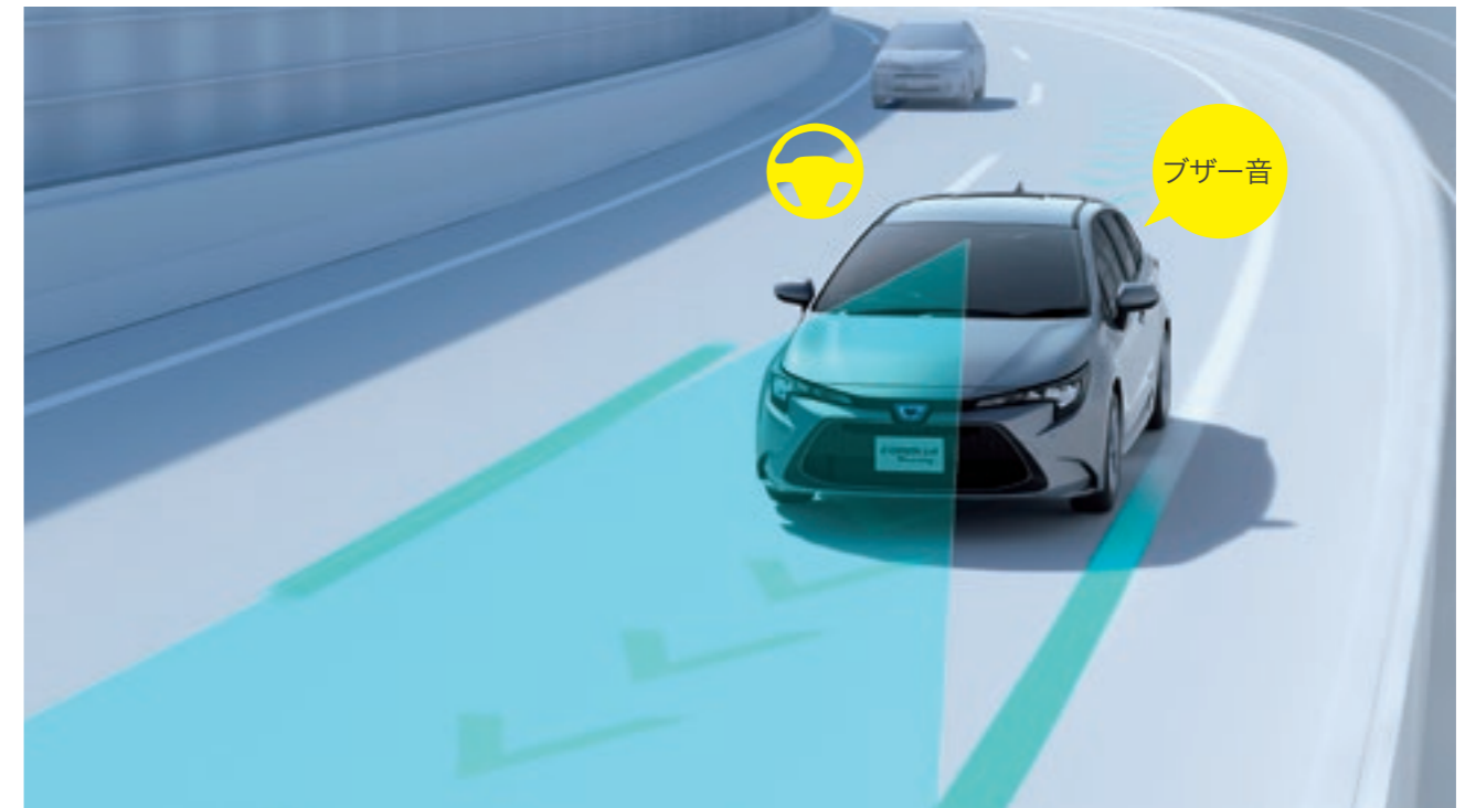
車線をはみ出しそうなときは、ブザー&ディスプレイ表示に加え、ステアリング操作の一部を支援。
