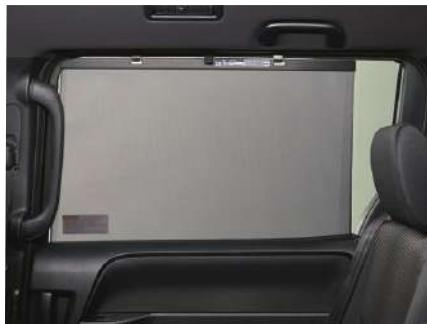
スライドドアのトリム内に、サンシェードを設定。直射日光を遮り、後席の方に快適なひとときを提供します。なお、サンシェードではカバーできないウインドウ両端にも遮光性を持たせることで、窓全面をしっかりと遮光します。
