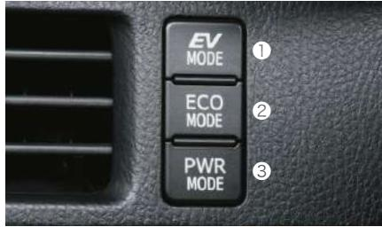
■設定した各モードスイッチをもう一度押せば、「通常走行モード」に戻ります。
