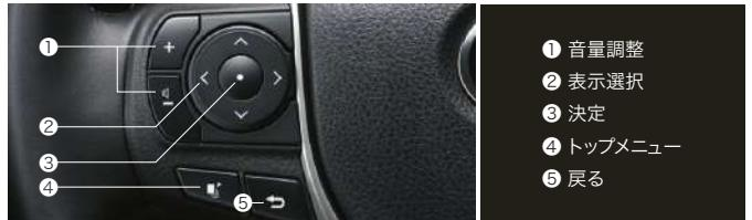
マルチインフォメーションディスプレイ内の表示切替やエアコンなどの操作を、ステアリングスイッチから手を離さずに行うことができ、運転に集中できます。4方向スイッチにより上下左右の操作を行えるので、縦横両方向に選択リストのある階層型メニューもスムーズに操作可能です。
