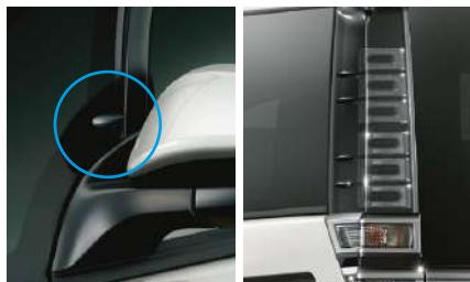
サイドガラス部とリヤコンビネーションランプサイド部には、気流に小さな渦を発生させ、車体を左右から押さえつけるエアロスタビライジングフィンを採用しました。また、リヤホイールハウス内には空力フィンを配置。さらに、床下への風の流れを抑制するセンターエアダムによって、優れた操縦安定性を実現しています。
