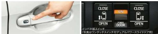
ワンタッチで簡単に開閉できるスイッチを採用。スマートキーを携帯していればワンタッチスイッチを押すだけで解錠&ドアオープンすることもでき、買い物で手荷物を抱えている時などに便利です。挟み込み防止機能<sup>\*1</sup>も備えています。
