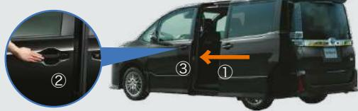
①パワースライドドア閉動作 ②スマートロック操作で施錠を予約 ③パワースライドドア閉後、施錠完了
