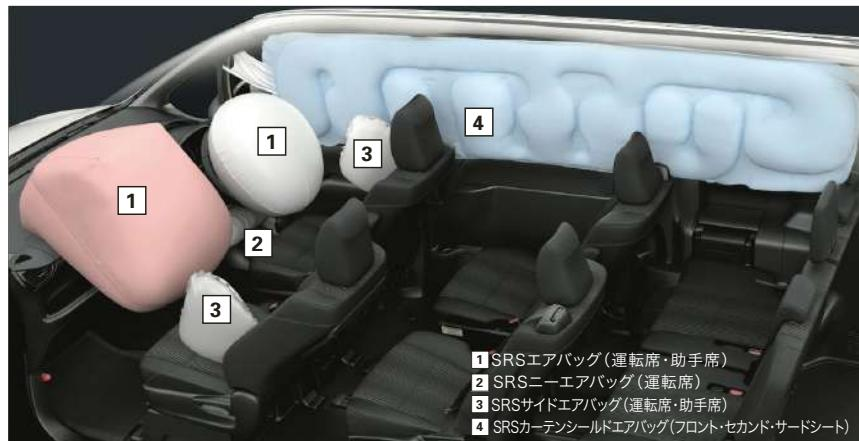
前席乗員の頭や胸の上体に作用する衝撃力を分散・緩和させるSRS\*6エアバッグから、サードシート乗員の頭部側面まで保護するSRSカーテンシールドエアバッグまで、合計7個のエアバッグを設定しています。
