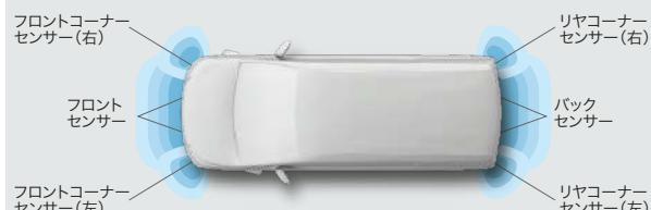
8つのソナーが静止物を検知し、自動(被害軽減)ブレーキが作動。
