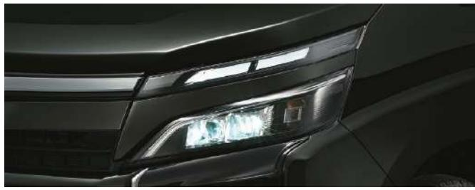
高輝度で点灯速度が速く、しかも消費電力の少ないLEDをハイ・ロービームとクリアランプに採用。さらに、先行車・対向車への眩惑防止に配慮し、車両姿勢の変化に応じて照射軸を一定に保つオートレベル機能付です。
