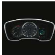
アナログメーター(シルバー加飾メーターリング)+4.2インチTFTカラーマルチインフォメーションディスプレイ ■写真はハイブリッド車。
