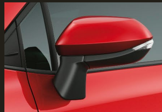
サイドターンランプ付オート電動格納式リモコンカラードアミラー (ヒーター・ブラインドスポットモニター付 [ボディ同色])
