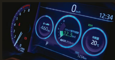
オプティロン3眼メーター + 7.0 インチ TFT カラーマルチ インフォメーションディスプレイ (スピードメーター表示)
