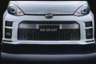
専用フロントバンパー/専用ラジエーターグリル (スモークメッキ加飾+ブラック塗装) ※写真は“GR SPORT・17インチパッケージ”
