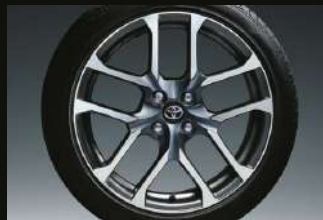
195/45R17タイヤ(ブリヂストンPOTENZA RE050A)&17×6½J “GR SPORT・17インチ パッケージ”専用アルミホイール(切削光輝) &専用センターオーナメント
