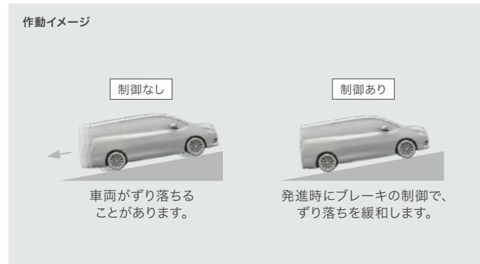
坂道での発進時、ブレーキからアクセルに踏み替える際に、ブレーキ油圧を保持することによって車両のずり落ちを緩和し、スムーズな発進を実現します。
