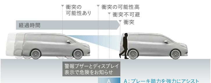
■プリクラッシュセーフティの警報は対車両の場合は自車速度約15km/h~140km/h\*、対歩行者(昼間)の場合は自車速度約15km/h~65km/h、自動(被害軽減)ブレーキは対車両の場合は自車速度約10km/h~80km/hで、対歩行者(昼間)の場合は自車速度約10km/h~65km/hで作動します。また、道路状況、車両状態、天候状態およびドライバーの操作状態等によっては、作動しない場合があります。詳しくは取扱書をご覧ください。 ■プリクラッシュセーフティはあくまで運転補助機能です。本機能を過信せず、必ずドライバーが責任を持って運転してください。 ■数値は社内測定値。
