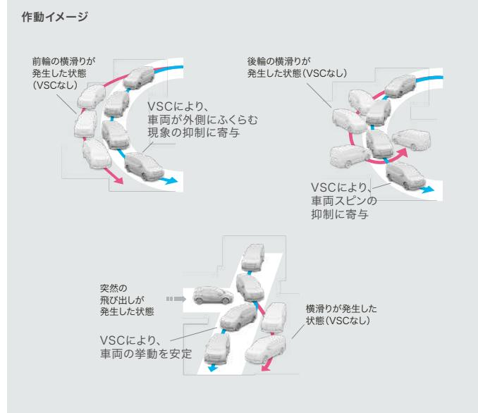
S-VSC<sup>\*1</sup>は、ステアリング制御(EPS<sup>\*2</sup>)、ブレーキ制御(VSC<sup>\*3</sup>、ABS<sup>\*4</sup>)、駆動力制御(VSC、TRC<sup>\*5</sup>)を協調して制御します。例えば、滑りやすい路面でのコーナリング時などに、車両の挙動が安定する方向に操舵トルクをアシスト。優れた操縦性と走行安定性を実現します。
