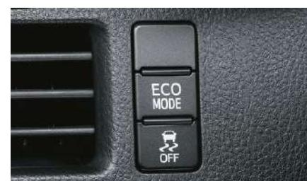
スイッチを押すと、アクセル操作に対する駆動力を穏やかにすると同時に、暖房・冷房の効き具合を抑えるなど、燃費重視の制御に。環境に配慮した運転をサポートし、燃費のさらなる向上にも貢献します。
