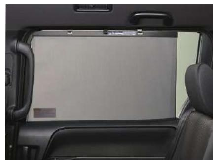
スライドドアのトリム内に、サンシェードを設定。直射日光を遮り、後席の方に快適なひとときを提供します。なお、サンシェードではカバーできないウインドウ両端にも遮光性を持たせることで、窓全面をしっかり遮光します。
