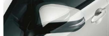
ドアの施錠・解錠に連動してドアミラーが自動で格納・復帰するオート格納機能を搭載。スイッチ操作の手間が省けるのはもちろん、駐車時の格納忘れ、発進時の出し忘れも解消し、さらに降車後もミラーを見ることでドアのロック状態が確認できます。
