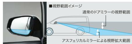
助手席側ドアミラーの鏡面下部に、アスペリカルミラー（非球面ミラー）を採用。駐車枠の左側のラインが見やすくなることで、後退駐車がしやすくなります。
