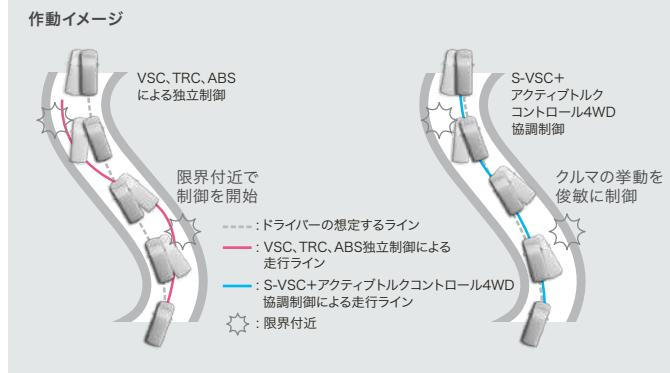
S-VSC<ステアリング制御(EPS)、ブレーキ制御(VSC、ABS)、駆動力制御(VSC、TRC)>と4WD制御が互いに協調し合い、制御を行うことで、滑りやすい状況下でもドライ路面でも優れた車両安定性を確保します。
