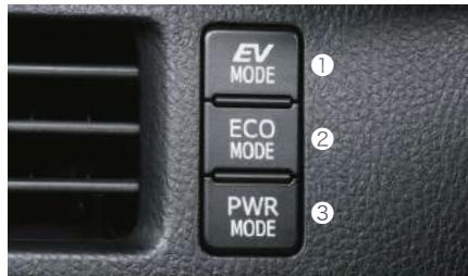
■設定した各モードスイッチをもう一度押せば、「通常走行モード」に戻ります。
