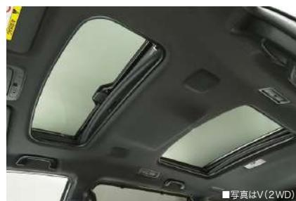
フロント側は手動でチルト、リヤ側は電動でルーフの開閉が可能。挟み込み防止機能<sup>\*7</sup>も備えています。
