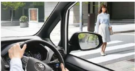
上方への視界を広げながら、インパネの形状を工夫することで、広々とした前方視界を確保。運転席からクルマのボンネットフードが見えるため、車両感覚がつかみやすく、狭い道も安心して運転できます。また、フロントピラーのスリム化や三角窓の拡大などにより、優れた側方視界を確保。さらにフロントドアガラスの下端を低く設定することで、巻き込みの回避もしやすく、安心して運転できます。
