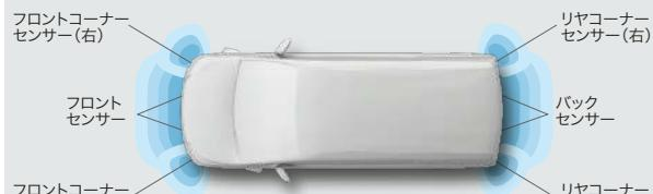
8つのソナーが静止物を検知し、自動(被害軽減)ブレーキが作動。
