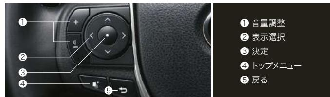
マルチインフォメーションディスプレイ内の表示切替やエアコンなどの操作を、ステアリングから手を離さずに行うことができ、運転に集中できます。4方向スイッチにより上下左右の操作を行えるので、縦横両方向に選択リストのある階層型メニューもスムーズに操作可能です。
