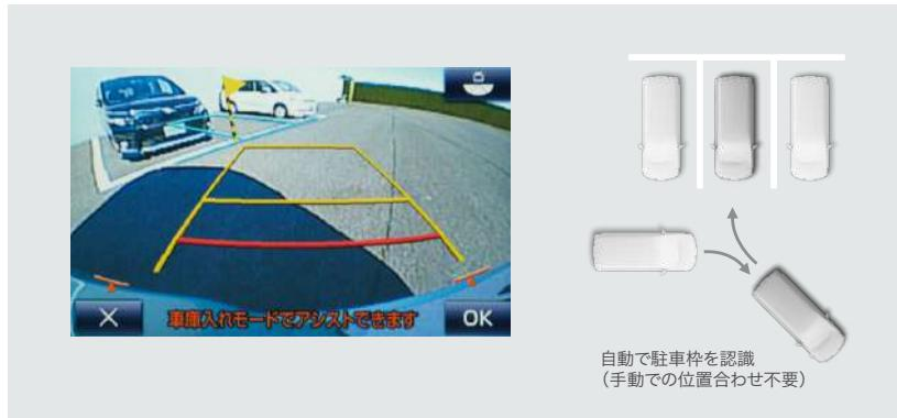
車庫入れ時に、車両がステアリング操作をアシスト。シフトを「R」に入れるだけで駐車枠を認識し、OKボタンをタッチすれば駐車枠にまっすぐ入るように自動でステアリング操作を行います。目標駐車位置を自動的に補正する機能も装備しており、ドライバーは周囲の安全確認とブレーキによる速度調整を行うだけで駐車区画の中央付近に精度良く駐車可能です。
