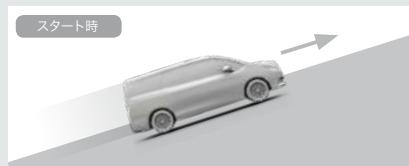
坂道でアイドリングストップ状態から再始動する時は、坂道発進補助機能が車両の後退を緩和します。
