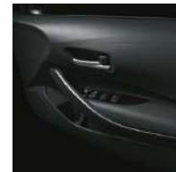
ドアトリムガーニッシュ(シルバー塗装)+ファブリックドアアームレスト表皮
