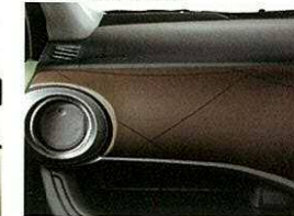
インパネ助手席オーナメント(合皮巻き)メッキ加飾(サイドレジスター)
