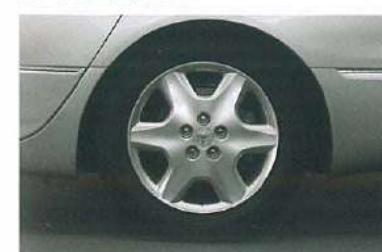
225/55R17 95W+17×7.5Jアルミホイール (スーパークロームメタリック)
