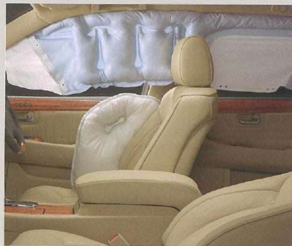
●SRSサイドエアバッグ(運転席・助手席)& SRSカーテンシールドエアバッグ(前後席)
