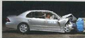
オフセット前面衝突試験 (64km/h 写真は実験用試作車です。)
