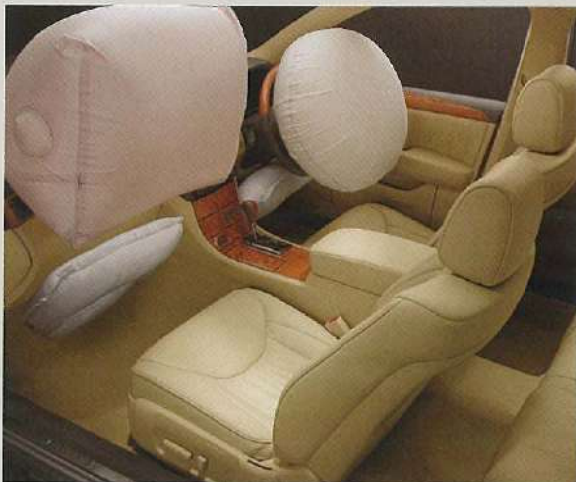
●デュアルステージSRSエアバッグ(運転席・助手席2段式)& SRSニーエアバッグ(運転席・助手席)
