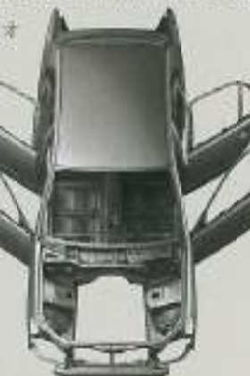
Off-set Frontal Impact Test (40% Lap) 写真は試験状況を示しています。
