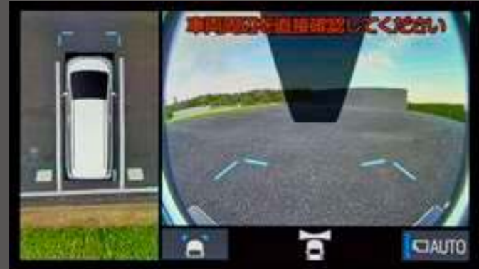
パノラミックビュー&ワイドフロントビュー [D・Nポジション時]
