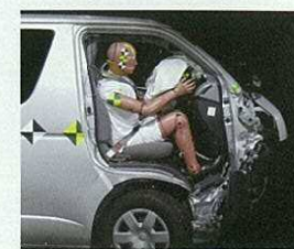
実験車両でオフセット前面衝突実験
