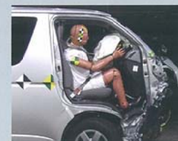
衝突時の衝撃荷重を効率的に分散・吸収して、キャブの变形を抑制。客室空間をしっかりと確保します。 ■写真は実験用車両でオフセット前面衝突実験です。
