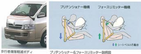
歩行者傷害軽減ボディ プリテンショナー&フォースリミッター説明図
