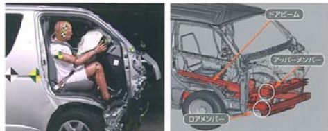
■写真は実験用車両でオフセット前面衝突実験です。
