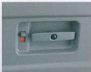
バックドアインサイドハンドル ★●はフック位置 (※については3人乗りのみ)
