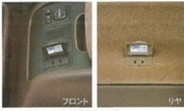
アクセサリコンセント(AC100V) フロント/フロントセンター/コンソールボックス前部に設置、 リヤ/サイドシート/シート前部サイドリムに設置。 ※電気機器により使用できない場合があります。 詳しくは販売店にご確認ください。
