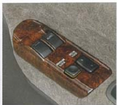
木目調スイッチベース&パワーウィンドウ (運転席・キーOFF後作動可能ワンタッチ式・ 挟み込み防止機構付) & ドアキー連動電気式 ドアロック
