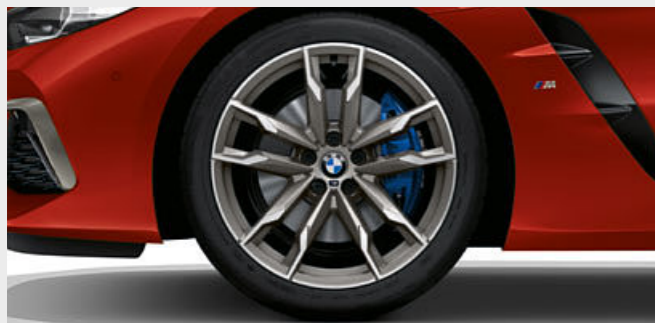
* 19インチ M ライト・アロイ・ホイール・ダブルスポーク・スタイリング800M バイ・カラー* (フロント) 9J×19ホイール、255/35ZR19タイヤ、 (リヤ) 10J×19ホイール、275/35ZR19タイヤ
