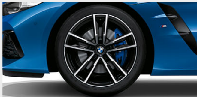
□ 19インチ M ライト・アロイ・ホイール・ダブルスポーク・スタイリング799M バイ・カラー* (フロント) 9J×19ホイール、255/35ZR19タイヤ、 (リヤ) 10J×19ホイール、275/35ZR19タイヤ
