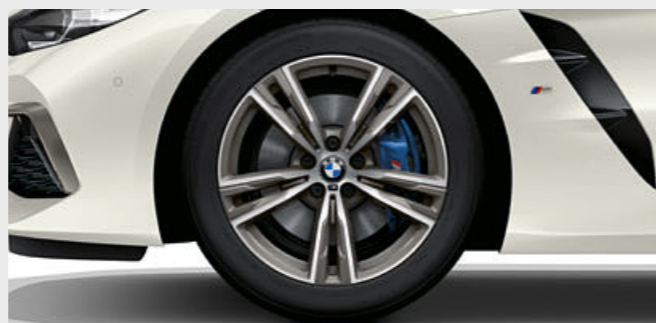
* 18インチ M ライト・アロイ・ホイール・ダブルスポーク・スタイリング798M バイ・カラー* (フロント) 8J×18ホイール、225/45ZR18タイヤ、 (リヤ) 9J×18ホイール、255/40ZR18タイヤ
