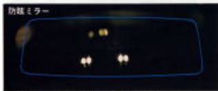
① 防眩式バックミラー…回転して上下の位置調整ができます
