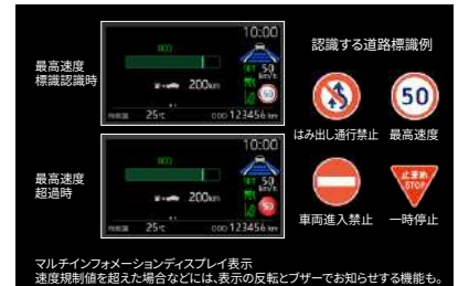
マルチインフォメーションディスプレイ表示 速度規制値を超えた場合などには、表示の反転とブザーでお知らせする機能も。
