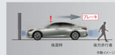
後退して出庫する際、自車後方の歩行者の存在を、12.3インチワイドディスプレイ、およびリヤパザードでお知らせします。自車後方の歩行者と衝突する可能性が高いと判断した場合、自動(被害軽減)ブレーキをかけます。 **全車**
