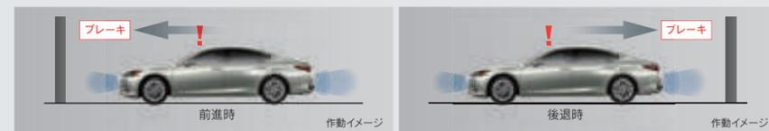
低速走行時に壁などの静止物までの距離と危険度を、カラーヘッドアップディスプレイとマルチインフォメーションディスプレイ、およびフロント・リヤパザードなどでお知らせします。低速走行時に壁などの静止物と衝突する可能性が高いと判断した場合、自動(被害軽減)ブレーキをかけます。 **全車**
