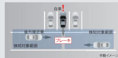
後退して出庫する際、自車後側方から接近する車両の存在を、ドアミラー、12.3インチワイドディスプレイ、およびリヤパザードでお知らせします。自車後側方から接近する車両と衝突する可能性が高いと判断した場合、自動(被害軽減)ブレーキをかけます。 **全車**
