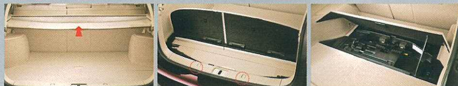
バックドア運動自動巻き取りノカバー プッシュオープン式デッキアンダートレイ 大型デッキアンダートレイ
