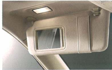
■サンバイザー (運転席・助手席 / パニティミラー&ランプ付)
