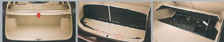
バックドア連動自動巻き取りノカバー フッシュオープン式テックアンダートレイ 大型テックアンダートレイ
