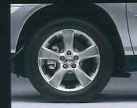
235/55R18スチールラジアルタイヤ(M+S)&18×7JJアルミホイール(スーパークロームメタリック)
