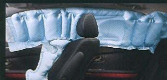
SRSサイドエアバッグ(運転席・助手席) & SRSカーテンシールドエアバッグ(前後席)
