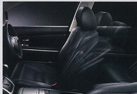
マルチアジャスタブルパワーシート (運転席8ウェイ・助手席4ウェイ)
