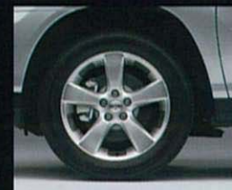
235/55R18スチールラジアル タイヤ&18×7JJアルミホイール (スーパークロームメタリック)
