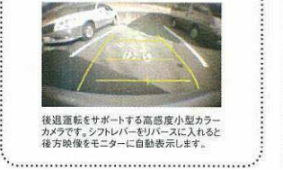
後進運転をサポートする高感度小型カラーカメラです。シフトレバーをPに入れたとき後方映像をモニターに自動表示します。
