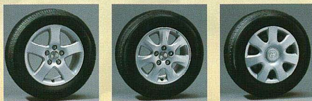
215/60R16 95H スチールラジアルタイヤ & 16×6 1 / 2 JJ アルミホイール 205/65R15 94H スチールラジアルタイヤ & 15×6 1 / 2 JJ アルミホイール 205/65R15 94H スチールラジアルタイヤ & 15×6 1 / 2 JJ スチールホイール (樹脂フルキャップ)
