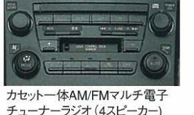
カセット一体AM/FMマルチ電子チューナーラジオ(4スピーカー)
