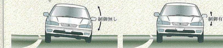
アンチロール制御=コーナリング時のロールの抑制
