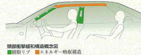
頭部衝撃緩和構造概念図 ■樹脂リブ ■エネルギー吸収構造
