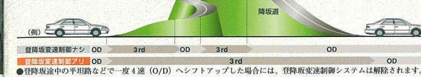
登降坂変速制御システム作動イメージ
