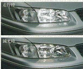
ヘッドランプ減光システム
