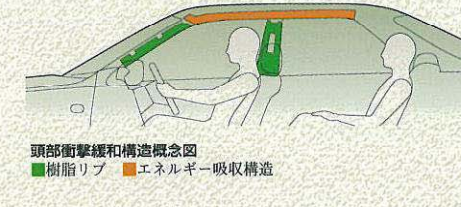
頭部衝撃緩和構造概念図 ■樹脂リブ ■エネルギー吸収構造
