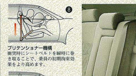
プリテンショナー機構 衝突時にシートベルトを瞬時に巻き取ることで、乗員の初期拘束効果をより高めます。
