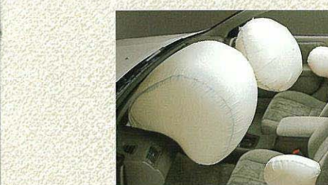
●写真は機能説明のためにすべてのSRSエアバッグが作動した状態をイメージしたものです。なおSRSサイドエアバッグは、実際の衝突時には衝突側のみ膨らみます。
