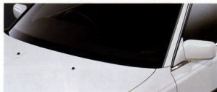
7. フルコンシールド&amp;ウォッシャー連動時間調整式欠ミスト付ワイパー
