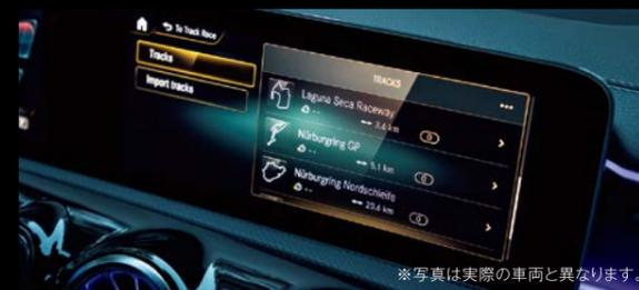
サーキット走行時のラップタイム向上に役立つAMGトラックベース\*サーキットでラップタイム、セクタータイム、ターゲットタイムとの差が確認できるほか、エンジン出力・トルク、縦横加速度などを表示することが可能。自分のパフォーマンスが詳細に分析できるので、ラップタイム向上に貢献します。
