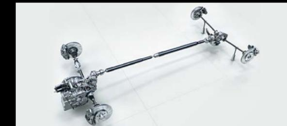
加速もコーナリングも思いのままのAMG 4MATIC走行状況とドライバーの意思に応じて前後トルクを100:0~50:50で配分。エンジンパワーを余すところなく路面に伝達しながらの強烈な発進、ワインディングロードでの一体感を極めたコーナリングなど、歓びに満ちた走りが愉しめます。
