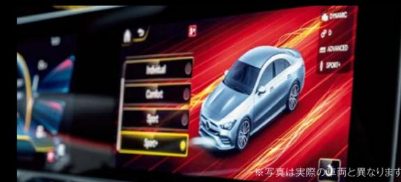
望みのままのセッティングを叶えるAMGダイナミックセレクトエンジン特性などが連動して変化。滑りやすい路面のための「Slippery」、快適性と燃費重視の「Comfort」、スポーティな「Sport」「Sport+」、様々なパラメーターを個別に設定できる「Individual」が選べます。
