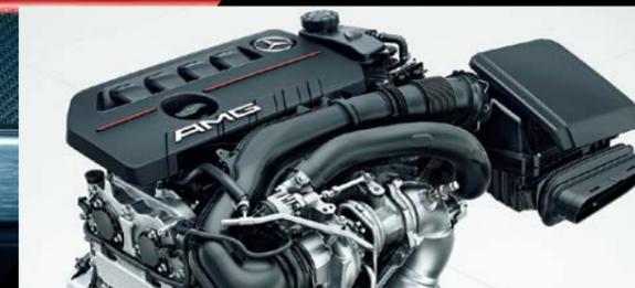
瞬時に溢れ出すパワーと環境性能を新たなレベルで両立させた2.0ℓ 直列4気筒直噴ターボエンジン(エンジン型式:M260)ツインスクロールターボチャージャーの採用で、低回転からの素早いレスポンスと高回転までのスムーズな吹け上がりを実現。全域で、意のままの力強い加速が愉しめます。可変バルブコントロールシステムの採用で優れた環境性能も獲得しています。
