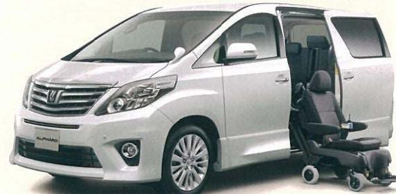
Photo:240S。サイドリフトアップシート車(脱着タイプ)「電動式」。
