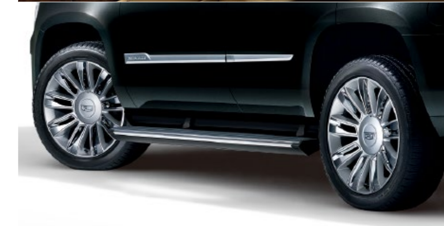
パワーリトラクタブルアシストステップ(LEDライティング付)
