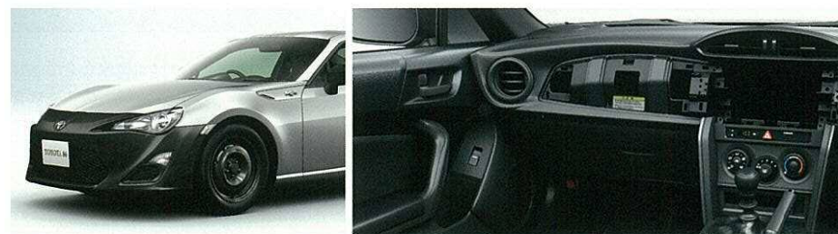
RCグレードはバンパーやドアミラーを素地色とするなど、アイテムや機能を簡素化。カスタマイズのしやすさと車両重量のさらなる軽減を実現し、レースへの参戦やドレスアップへのこだわりを徹底してサポートする。
