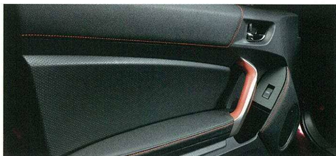
ドアトリムのデザインは、カスタマイズして楽しむことを想定。ニーパッドやショルダーパッド部は、容易に取り外しやすい別体構成としている。
