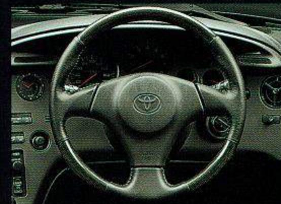
SRSエアバッグ内蔵カーボンφ370mmステアリン
