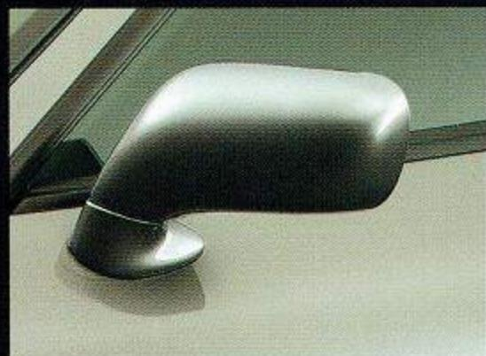
電動格納式リモコンカラードドアミラー
