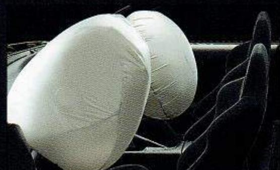
デュアルSRSエアバッグ(運転席・助手席SRSエアバッグ)
