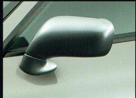
電動格納式リモコンカラードドアミラー
