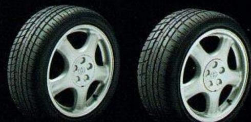
フロント235/45 ZR17・リア255/40 ZR17スチールラジアルタイヤ&アルミホイール[RZに標準。その他全車に17インチ専用ブレーキ、スポーツABSとセットでメーカーオプション]
